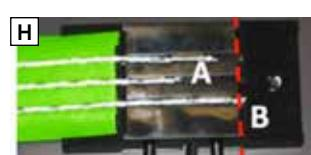
I Bevestig nu het Slakkenband met behulp van de meegeleverde schroeven. Advies is het Slakkenband te monteren met één schroef per circa 10cm, afwisselend bovenaan en onderaan (zigzag). Breng geen schroeven aan op minder dan 5mm afstand van de geleidende draden. Ook kunt U bijvoorbeeld het Slakkenband stevig vastlijmen op een paneel of ander soort stevige ondergrond.
