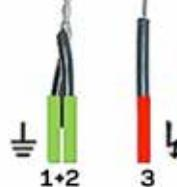
**2** Anslut (spännings-)tråden **3** (se punkt **D** och **K**) till den röda hållaren "FENCE" på elstångselaggregatet. Ta bort cirka 10 mm isoleringsmaterial från tråden. Öppna den röda klämman genom att trycka på den och placera kabeländarna i klämman. Kontrollera att kabeln är fastklämd.
